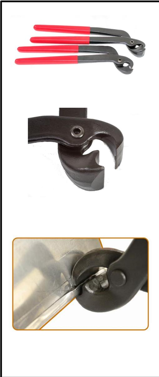
Bei vielen Instandsetzungsarbeiten im Karosseriebereich müssen Bördelungen teilweise oder ganz geöffnet werden. Die kann man mit verschiedenen Methoden erreichen.
