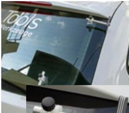
Mit der Spaltmaßlehre können optimal, selbst große Windschutzscheiben, auf den Millimeter genau eingepasst werden. Pro Halter sind Einstellungen zwischen 1-10mm möglich. Die Abstufungen erfolgen in 1mm Schritten.
